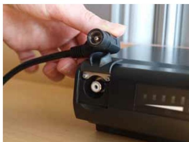
Primeiro ligue o carregador para a bateria e de alimentação AC. Um LED na parte superior do carregador indica que o estado do carregador. É vermelho quando a bateria está a carregar e fica verde quando a bateria é recarregada.
