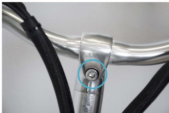
Parafuso de ajuste da inclinação do guidador
