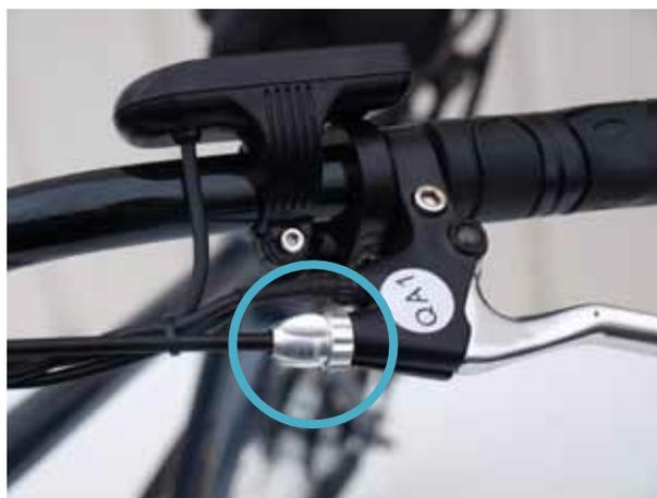
Afrouxar a braçadeira de cabo e puxar o cabo até que as almofadas são empurrados contra o aro. Apertar o Serre cabo (atenção particular está a ser feita para cada uma das extremidades da bainha que está para entrar sem forçar para dentro do alojamento de cada alavanca do travão lado de extremidade rígida e V-Brake).
