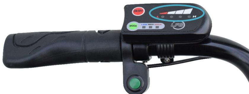
Cada poder as luzes sucessivamente para um teste de leitura, e estabilizado depois. Inicialmente com uma bateria carregada, os 4 LEDs são vermelhos. Você pode controlar a energia restante e adaptar o seu ritmo e modo de assistência.
