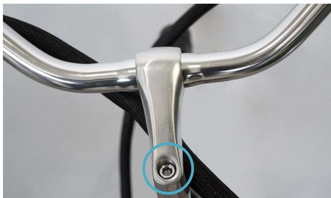
Parafuso de ajuste de altura
