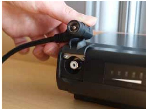
Primeiro ligue o carregador para a bateria e de alimentação AC. Um LED na parte superior do carregador indica o estado da carga. É vermelho quando a bateria está a carregar e fica verde quando a bateria é recarregada.
