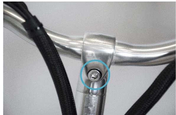
Parafuso de ajuste da inclinação do guidador
