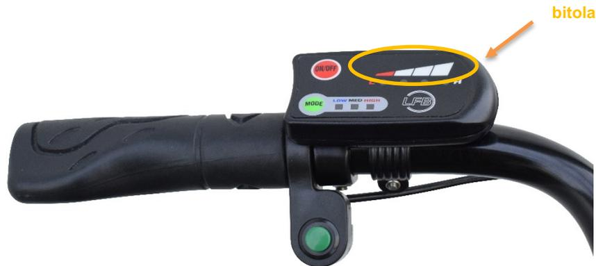
Cada poder as luzes sucessivamente para um teste de leitura, e estabilizado depois. Inicialmente com uma bateria carregada, os 4 LEDs são vermelhos. Você pode controlar a energia restante e adaptar o seu ritmo e modo de assistência.
