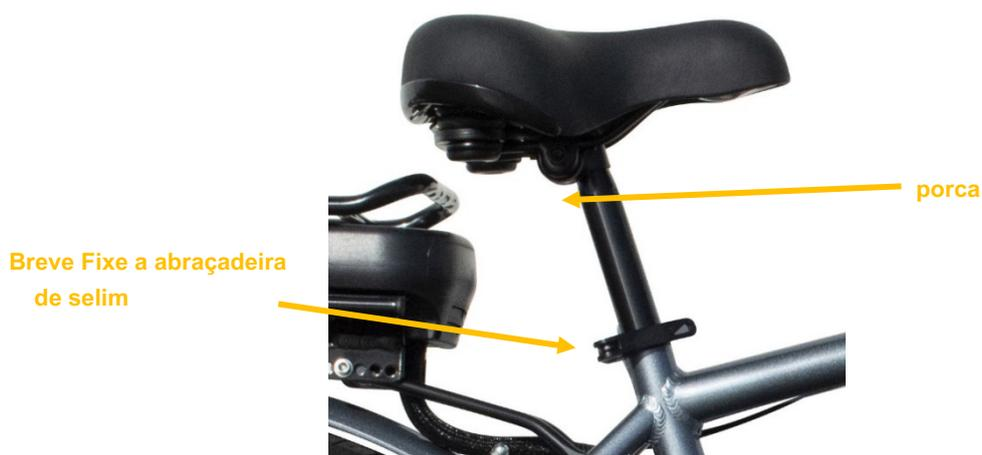
Sentado na sela calçados pé calçado adequado para andar de bicicleta, colocar um pedal na posição para baixo, coloque a ponta do pé sobre o pedal, a perna deve ser um pouco curvado. Aumentar ou diminuir o assento para obter a altura adequada. Pedalar para trás você não balançar os quadris.
