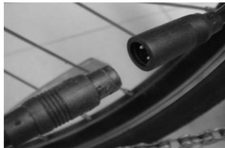
Cortar a ligação "Colson", que fixa o cabo do motor para o quadro. Remova as tampas porca esquerda e direita. Desaperte as porcas. Remover o eixo da roda porcas e anilhas. Soltar o travão de fixação do cabo V-freio para libertar as pastilhas de modo a remover a roda.
