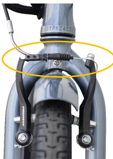
As almofadas adequadamente ajustados quando estão em igual distância do aro. O ajustamento final é feita por aperto dos parafusos montado no suporte do sapato com uma chave de fenda (distância de aproximadamente 0,1 a 0,5 mm a partir da borda).
