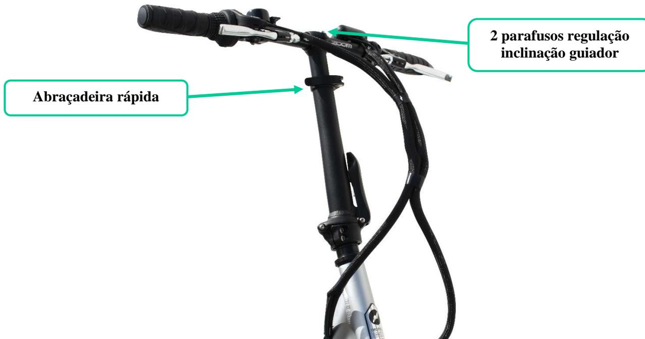
Certifique-se de que volta a apertar a abraçadeira rápida antes de utilizar a bicicleta.
