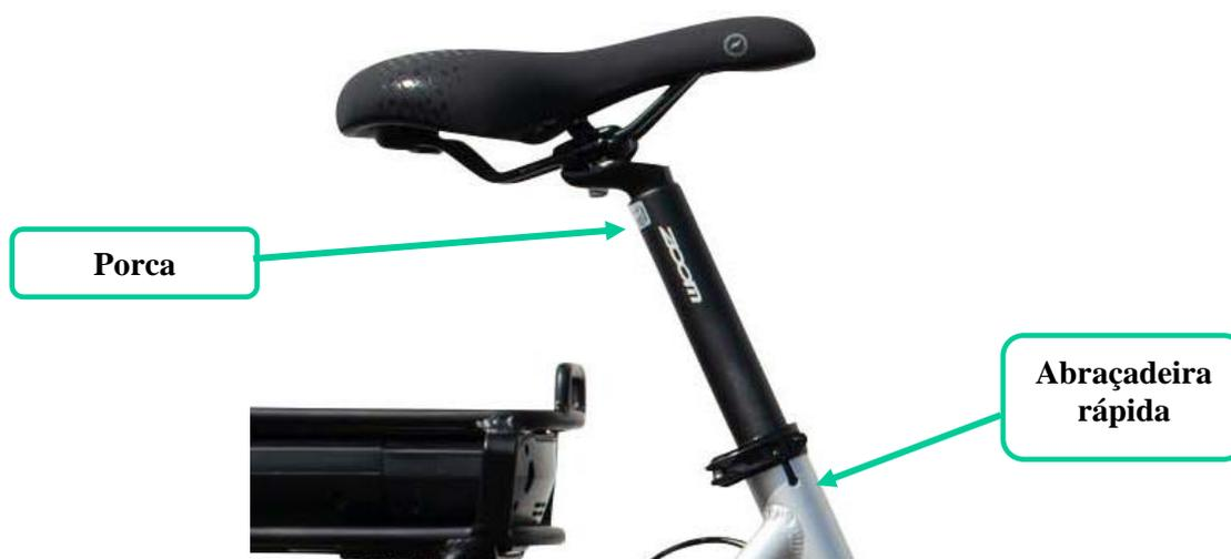
Sentado sobre o selim, utilizando calçado adaptado para a prática de bicicleta, coloque um dos pedais na posição baixa, pouse o calcanhar sobre o pedal, devendo a perna cair normalmente sem ficar esticada. Suba ou desça o selim para conseguir a melhor altura. Ao pedalar ao contrário, não deve bambolear-se.
