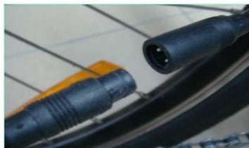
Corte a ligação «Colson» da fixação do cabo motorizado sobre o quadro. Retire as proteções das porcas das rodas direita e esquerda. Desaperte as porcas. Retire as porcas e as anilhas do eixo da roda. Desaperte a abraçadeira do cabo do travão V-Brake a fim de libertar os patins para poder retirar a roda. Remova a corrente do pinhão da roda, prestando atenção ao balanceamento da corrente.
