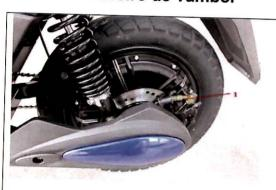
1(parafuso guia do travão): ajuste do travão traseiro:
