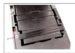
1(fechadura da caixa da bateria): para trancar a caixa da bateria, rodar a chave 180º no sentido horário. Para destrancar a caixa da bateria, rodar a chave 180º no sentido anti-horário.
