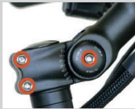
Para ajustar o ângulo e a altura do encaixe do guidador, desaperte os parafusos indicados com uma chave Allen de 5 mm.
