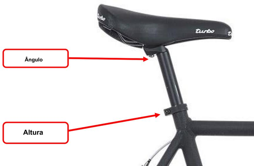
Calçando sapatos de ciclismo adequados, sente-se no selim, coloque um dos pedais na posição mais baixa, apóie um calcanhar no pedal e sua perna deverá repousar normalmente no pedal sem ser esticada. Levante ou abaixe a sela para obter a altura correta. Ao pedalar para trás, você não deve mover os quadris de um lado para o outro.
