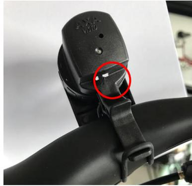
❖ Uma luz vermelha traseira alimentada por bateria ( 2 x baterias LR03) que é ativado por um interruptor na parte inferior da luz.
