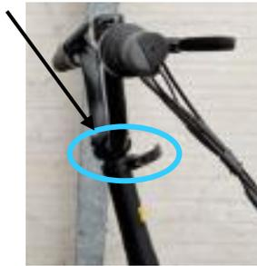
3. Dobrar a parte frontal do quadro: desparafuse a porca borboleta, posicione a parte de fechamento corretamente no triângulo traseiro,
