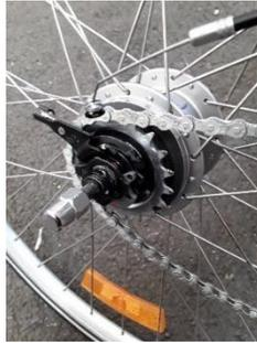
Solte a corrente da roda dentada, prestando atenção à inclinação da corrente.
