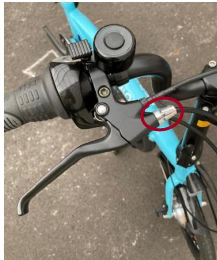
Afrouxe a braçadeira do cabo na pinça do freio. Posicione o cabo na braçadeira de cabo. Aperte a braçadeira do cabo (cuidado especial deve ser tomado em cada extremidade da bainha que deve entrar sem forçar no alojamento de cada extremidade rígida, no lado da manivela do freio).
