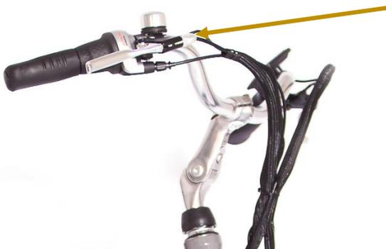
Desaperte a abraçadeira do cabo e puxe o cabo até os patins tocarem na jante. Desaperte a abraçadeira do cabo (deve ser dada especial atenção a cada extremidade da bainha que deve entrar sem forçar no compartimento de cada ponta rígida, do lado da alavanca do travão e do V-Brake.)
