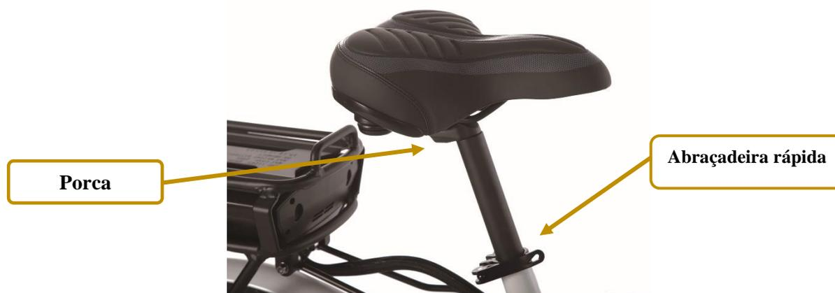
Regule a inclinação do selim, a fim de obter a posição mais adaptada ao seu conforto. Volte a apertar a porca, binário de aperto máximo de 13 Nm.
