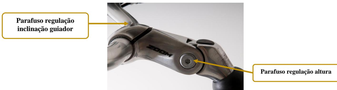
Proceda da mesma forma com o segundo parafuso para a regulação da inclinação do guiador. Após a regulação, volte a apertar com força os parafusos, binário de aperto máximo: 10 Nm.
