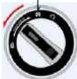
Fechadura de ignição
