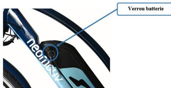
Para substituir a bateria, primeiro posicione a parte inferior corretamente e, em seguida, incline a bateria em seu compartimento.
