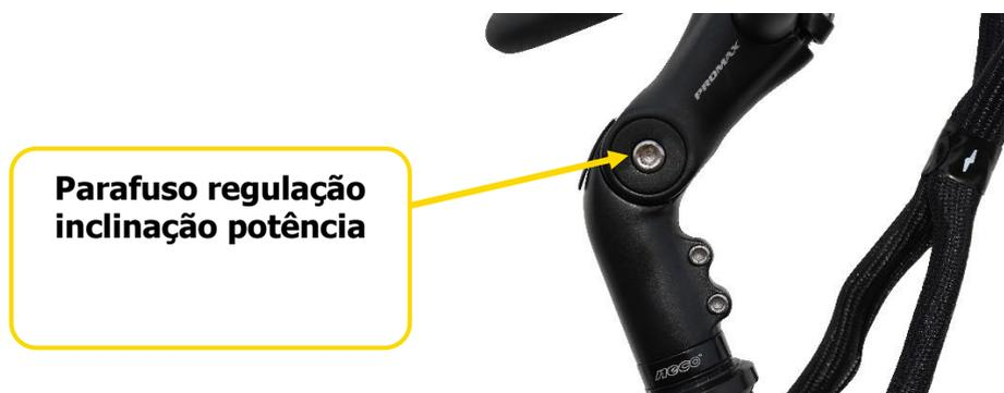
Após a regulação, volte a apertar com força os parafusos, binário de aperto máximo: 14 – 15 Nm.
