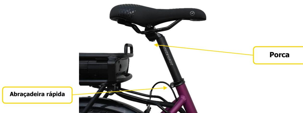
Após a regulação, volte a apertar com força os parafusos, binário de aperto máximo: 8 Nm
