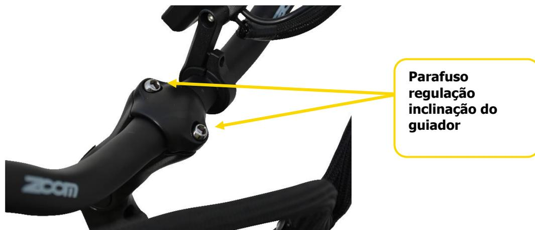
Para ajustar a inclinação do guidor, desaperte um dos dois parafusos com uma chave Allen de 5mm. Após a regulação, volte a apertar com força os parafusos, binário de aperto máximo: 11 – 12 Nm.
