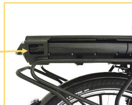
Um díodo que se encontra acima do carregador indica o nível de carga da bateria. Fica vermelho quando a bateria está a carregar e passa para verde quando a bateria está recarregada.
