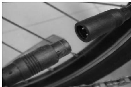
Corte a ligação «Colson» da fixação do cabo motorizado sobre o quadro. Retire as proteções das porcas das rodas direita e esquerda. Desaperte as porcas. Retire as porcas e as anilhas do eixo da roda. Desaperte a abraçadeira do cabo do travão V-Brake a fim de libertar os patins para poder retirar a roda. Remova a corrente do pinhão da roda, prestando atenção ao balanceamento da corrente.
