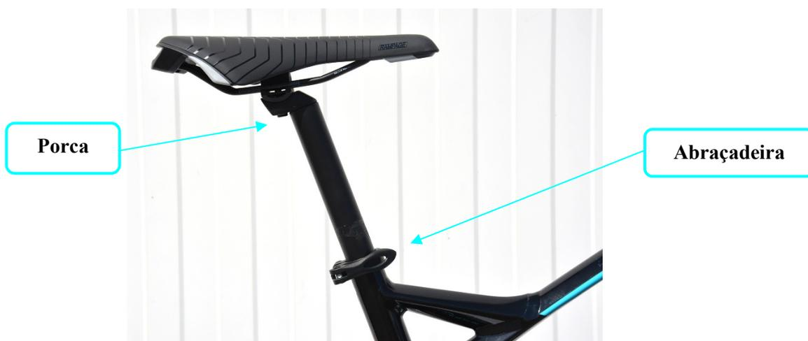
Sentado sobre o selim, utilizando calçado adaptado para a prática de bicicleta, coloque um dos pedais na posição baixa, pouse o calcanhar sobre o pedal, devendo a perna cair normalmente sem ficar esticada. Suba ou desça o selim para conseguir a melhor altura. Ao pedalar ao contrário, não deve bambolear-se.
