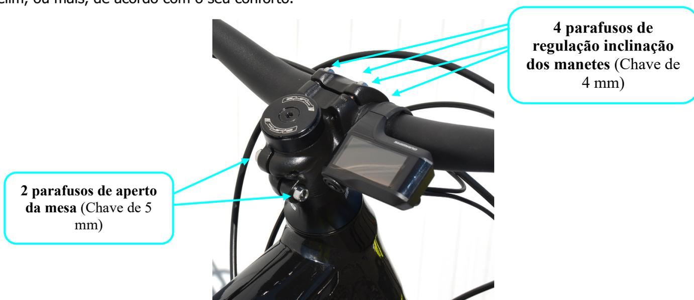
Após a regulação, volte a apertar os parafusos, binário de aperto máximo: 6 Nm para os manetes e 8 Nm para a mesa.
