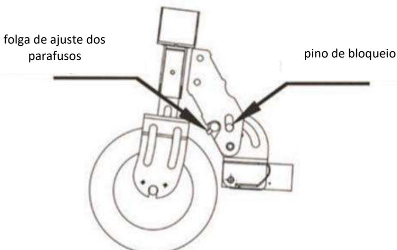
1. Quando o espaço no dispositivo dobrável é demasiado grande, o parafuso superior pode ser rodado para a direita com uma chave Allen e os parafusos esquerdo e direito devem ser ajustados.
