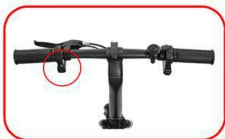
Como exibido na imagem, pode ligar e desligar o seu dispositivo usando o botão vermelho. Empurre para cima para ligar. E depois para baixo para desligar. Para ligar a luz frontal, pressionar o botão abaixo do indicador de bateria durante 3 segundos.
